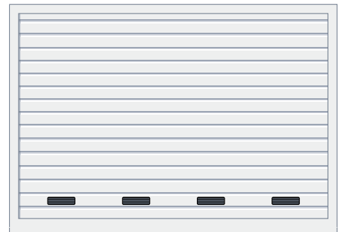
Motiv 480, lamellfyllning med ventilationsgaller Ventilationstvärsnitt: 40 cm 2 /galler
