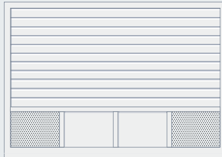
Motiv 499, exempel med lamell-, hålplåts- och aluminiumplåtfyllning
